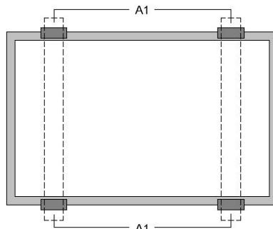
长边使用 4 个压块, 安装导轨与长边框垂直安装。
