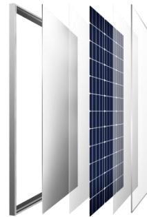
单玻组件结构为：玻璃、封装胶膜、电池、封装胶膜、背板、边框
