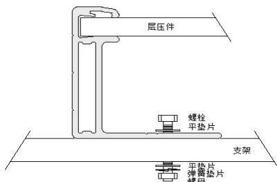
螺栓安装示意图
